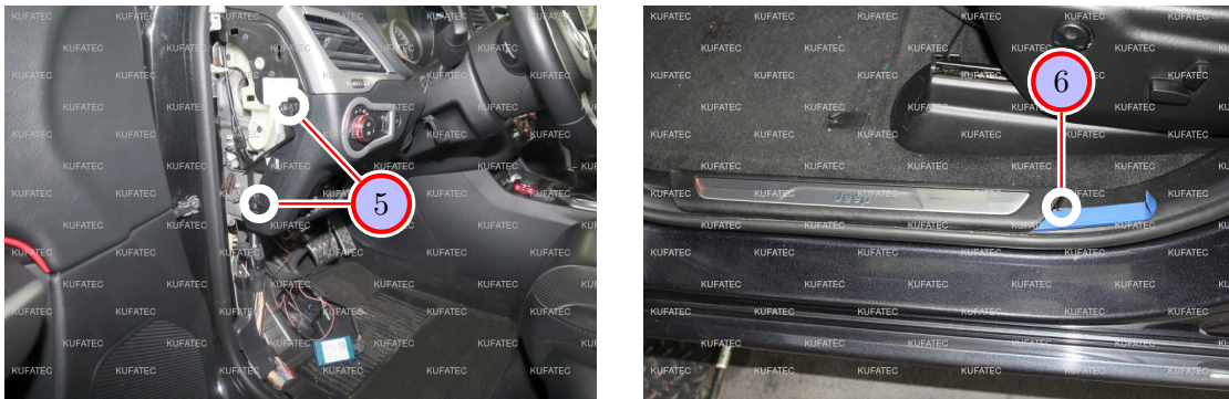
Abbildung 5: Demontage Verkleidungen Fahrerseite
