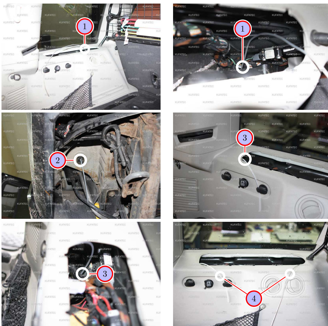
Abbildung 8: Leitungsverlegung zum Unterboden
