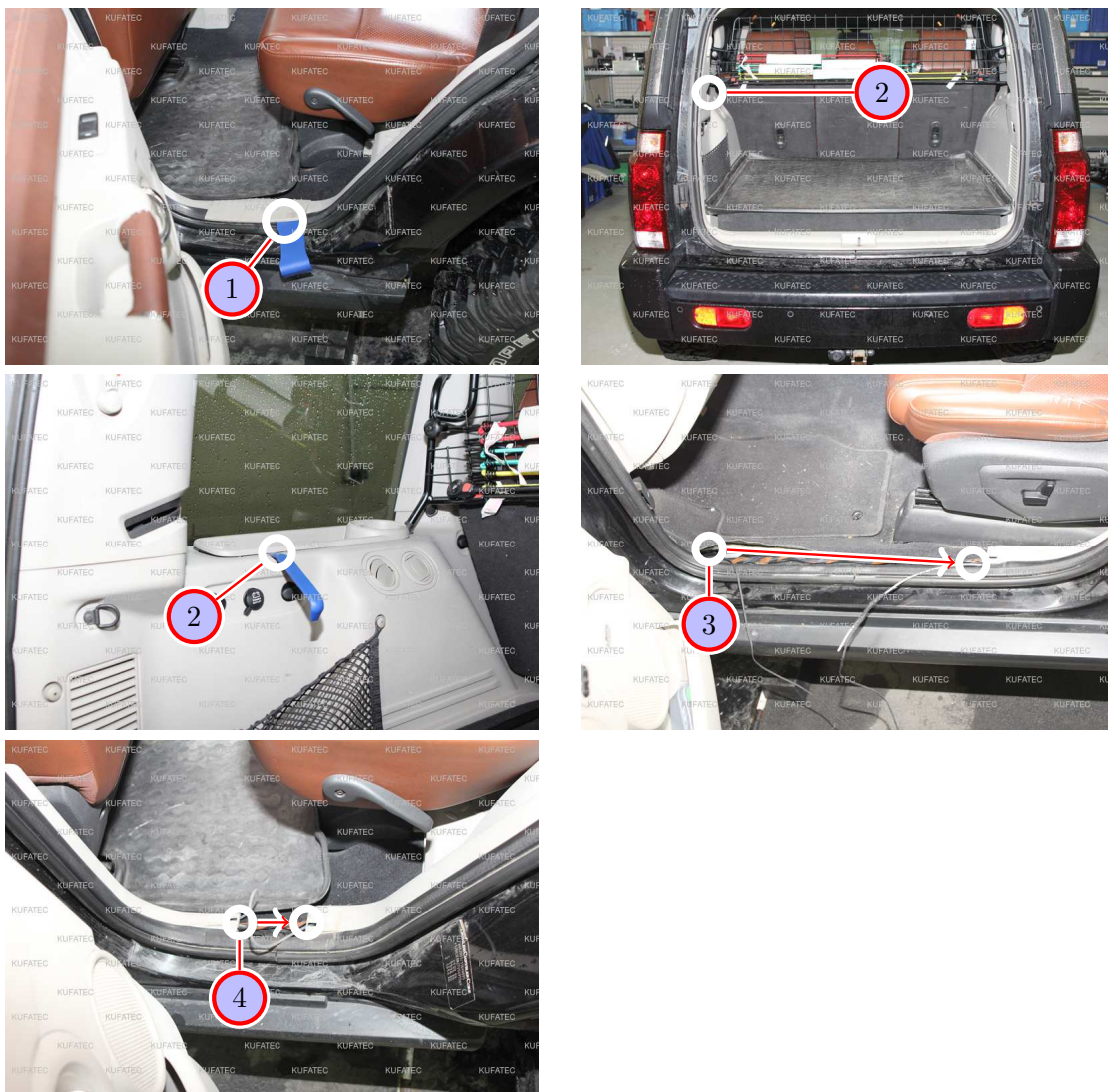
Abbildung 7: Leitungsverlegung zum Kofferraum
