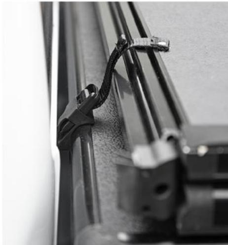
**ACHTUNG:** Fahren Sie niemals mit einer teilweise zusammengefalteten / geöffneten Abdeckung. Fahren Sie nur mit einer entfalteten und an den 4 Positionen gesicherten oder mit einer vollständig gefalteten Abdeckung die vorne mit zwei Klammerhaltern und den Gurten entsprechend dieser Beschreibung gesichert ist!
