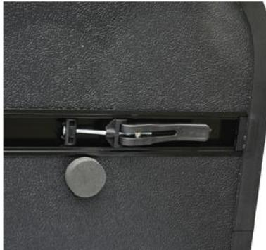
**Hinweis:** Wenn die Laderaumabdeckung vollständig zusammengefaltet ist, sichern Sie die Abdeckung, schließen Sie den Sicherungsgurt und ziehen Sie die Gurte fest über der Abdeckung zusammen.
