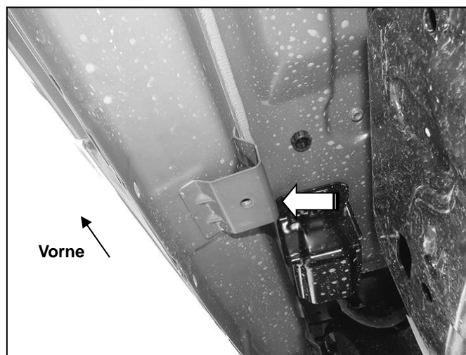
(Bild 4) Dritter Montagepunkt Beifahrerseite/Rechts
