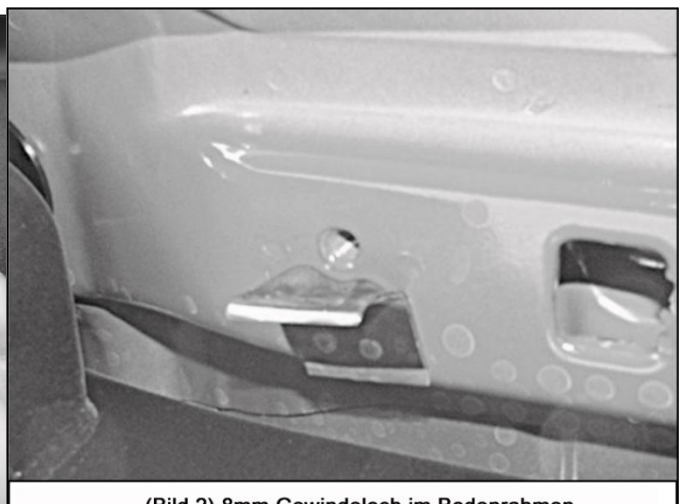
(Bild 2) 8mm Gewindeloch im Bodenrahmen (als Beispiel die Front der Beifahrerseite)
