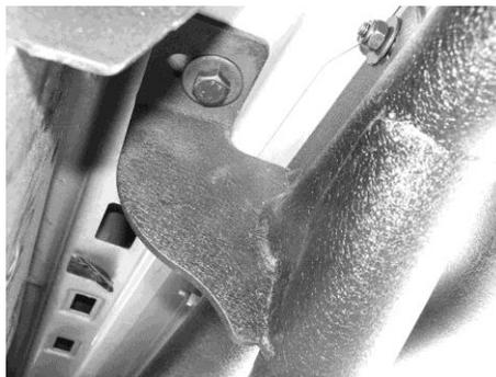
Abbildung 5 : Montage des Halters an der Fahrzeugseite vorne
