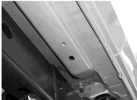
Abbildung 2 : Fahrzeuge mit Gewindebohrungen (ca. ab Baujahr 2010-2018)
