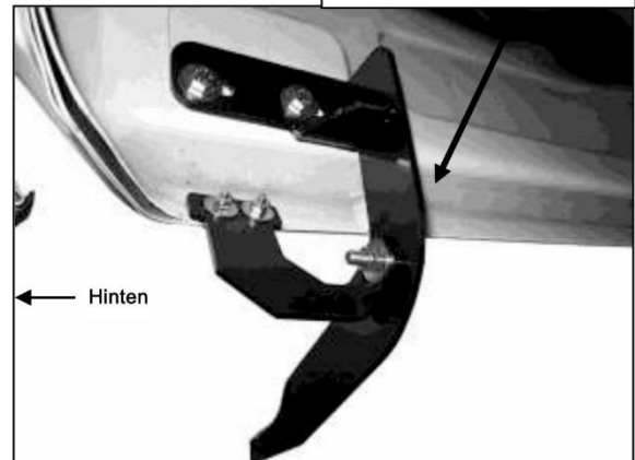
Bild 18 Montage der Halterung auf Fahrerseite hinten
