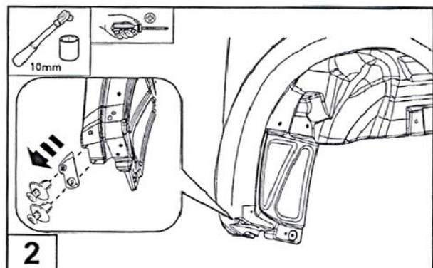
1. Zum Abnehmen des vorderen Schmutzfängers lösen Sie die 2 Nieten und die Sechskantschraube an der Unterseite des Kotflügels. Bewahren Sie die Schraube und den Schmutzfänger für die Wiederanbringung. Entfernen Sie die 3 Nieten von der Oberseite des Kotflügels, diese werden nicht mehr benötigt.
