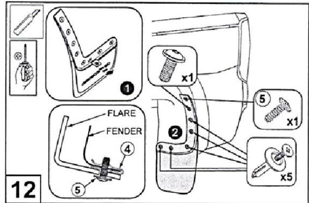
**11.** Montieren Sie den vorderen Schmutzfänger mit den 2 zuvor entfernten Nieten und der Sechskantschraube wieder am Fahrzeug.
