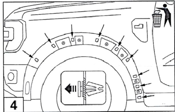
3. Entfernen Sie die Parksensoren und ziehen Sie die werksseitigen Kotflügelverbreiterungen vom Fahrzeug ab. **Hinweis: Die Halteclips werden dauerhaft beschädigt!!**
