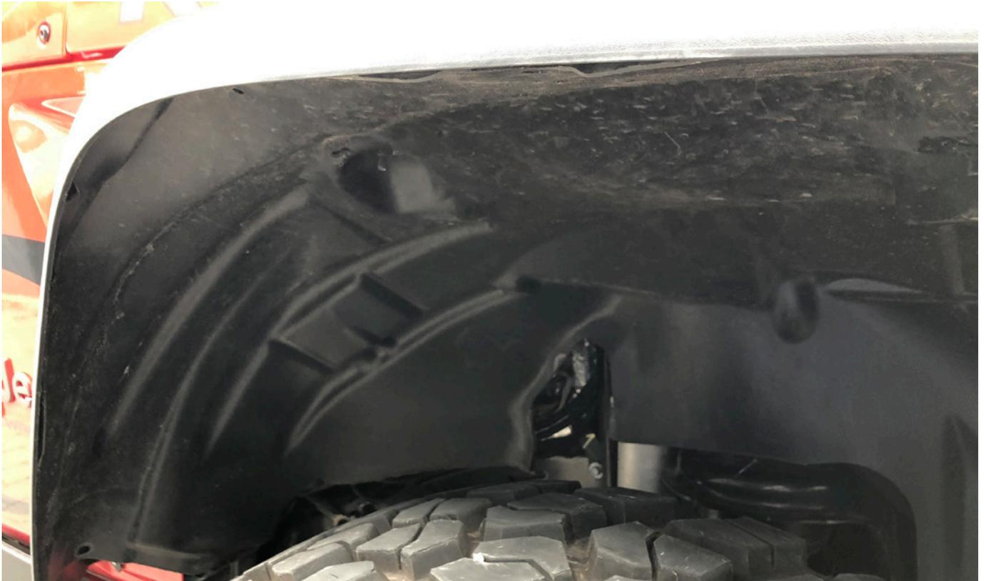
**7. Datenbuskabel mit 2-poligem weißem Stecker zur Sternverteilung durch die Gummitülle vom vorderen rechten Radhaus aus, zum Handschuhfach verlegen.**
