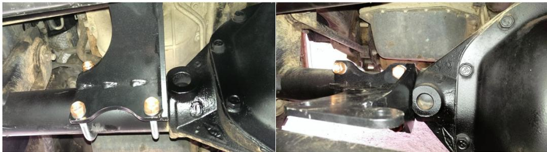
4. Setze nun die Halteschraube des Dämpfers in die äußeren Halter ein und verschraube diese mit den Bügelschrauben an der Spurstange. Die Seite mit Nase und Montageloch des Dämpfers muss dabei zur Fahrzeugmitte zeigen. Auf der Rückseite der Halter sind halbrunde Verstärkungen welche genau an die Spurstange passen. Verschraube die Halter nun wie abgebildet mit je 2 der Bügelschrauben. Ziehe die Bügelschrauben ebenfalls nur handfest an.
