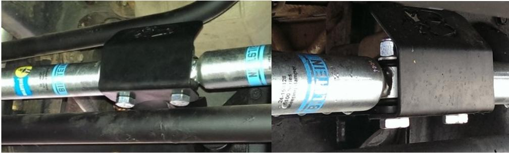
6. Nun richte den zentralen Halter so aus, daß dieser parallel zur Spurstange verläuft und die Dämpfer in einer Flucht nach links und rechts verlaufen. Ziehe die Srauben der Lenkungsdämpfer mit 50 Nm fest. Richte nun die beiden äußeren Halter ebenfalls so aus, daß die Halteschrauben gerade nach oben zeigen und ziehe diese mit 12 Nm fest.
