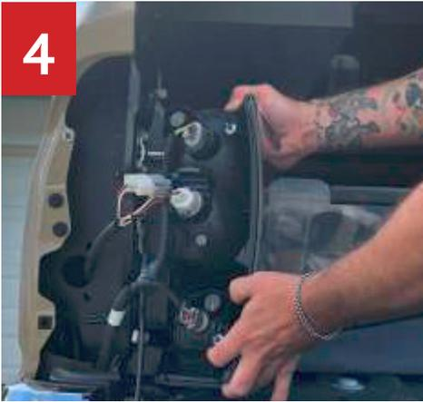
4. Lösen Sie das männliche Ende des Bremslichtkabels von der Rückleuchte und verbinden Sie es mit der Buchse des T-Kabelbaums. Dann verbinden Sie das männliche Ende des T-Kabelbaums mit der Rückleuchte.
