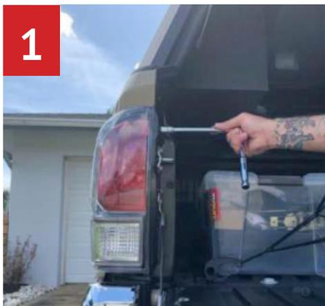
1. Entfernen Sie die linke Rückleuchte, wodurch der Hohlraum hinter der Rückleuchte freigelegt wird.
