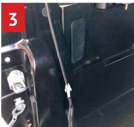
3. Stecken Sie den T-Kabelbaum zwischen den werkseitigen Stecker und den werkseitigen 7-poligen Stecker. Vergewissern Sie sich, dass beide Enden des T-Kabelbaums mit den Verriegelungslaschen vollständig eingeführt sind.
