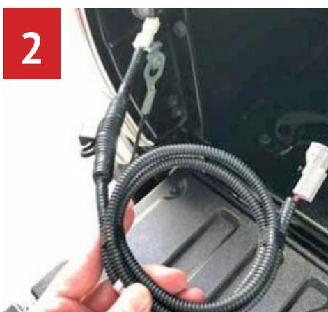
2. Nehmen Sie den 2-poligen Stecker für die dritte Bremsleuchte. Dieser hängt auf der linken Seite des Smartcaps, in der Nähe der Heckklappe herab. Schließen Sie den T-Kabelbaum daran an.
