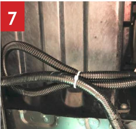
7. Sichern Sie lose Kabel mit einem Kabelbinder.
